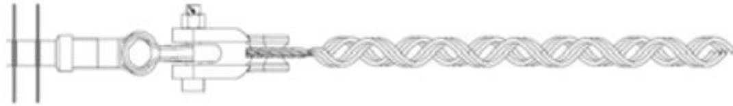
(ب) نحوه قرارگیری سیم گیر در زنجیره کششی
