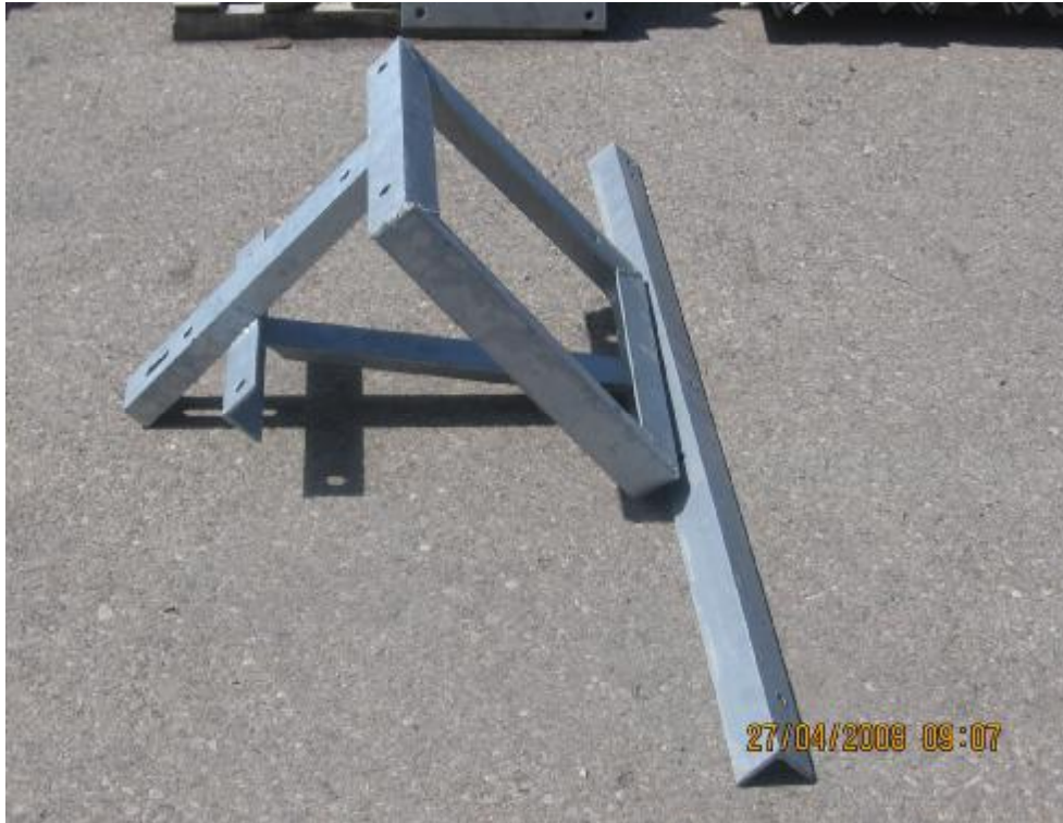
شکل (٨) - تصویر سکوی نصب کات اوت برقیگیر (شهرستان مشهد)
